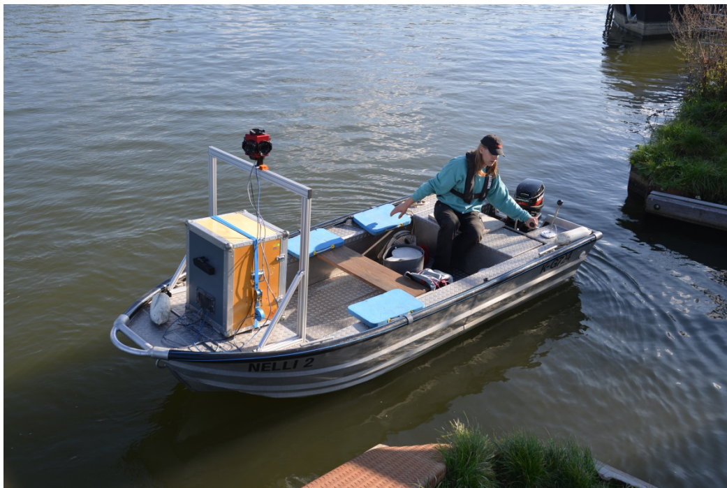
Abb.: Messboot Nelli2 mit installierter 360°-Panoramakamera
