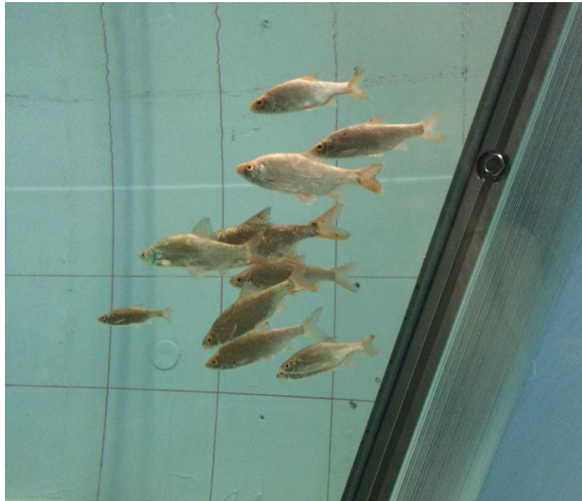
Abbildung 1: Blick aus dem Beobachtungsraum: Die Rotaugen bewegen sich als Schwarm und zeigen ein ausgeprägtes Sondierverhalten vor dem Rechen. Im Laufe des Versuchs wird protokolliert in welchen Bereichen vor dem Rechen sich die Fische bevorzugt aufhalten (Foto: IWW)
