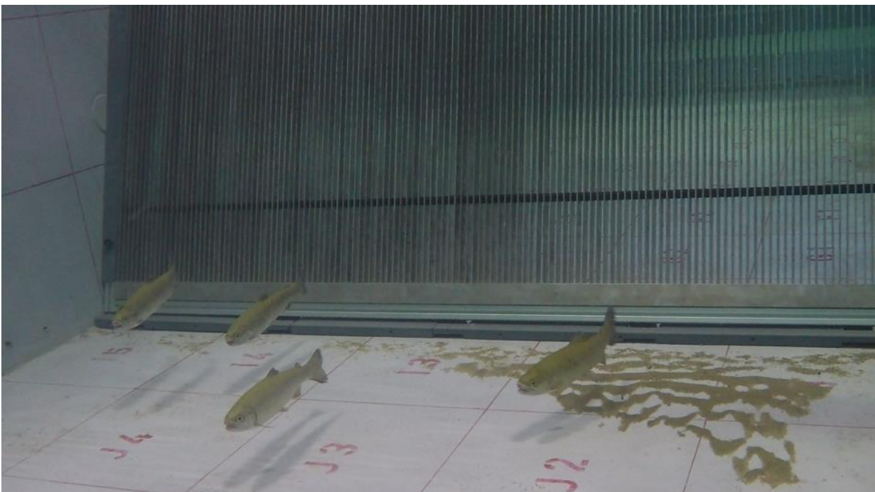
Abbildung 2: Blick in Strömungsrichtung: Die Forellen haben ein hohes Schwimmvermögen und können sich auch bei hohen Strömungsgeschwindigkeiten ohne Probleme vor dem Rechen bewegen (Foto: IWW)
