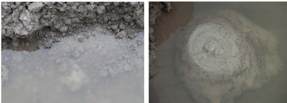
Abb. 8: Fotos von Sandspuren (links) und sandenden Auswurftrichtern (rechts)
