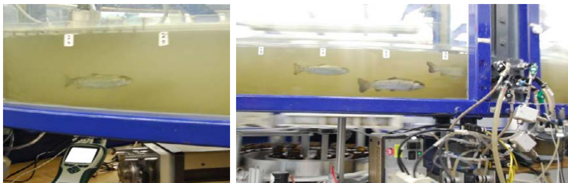
Abb. 14: Versuche im Kreisgerinne am IWW der RWTH Aachen mit Sedimenten und Fischen
