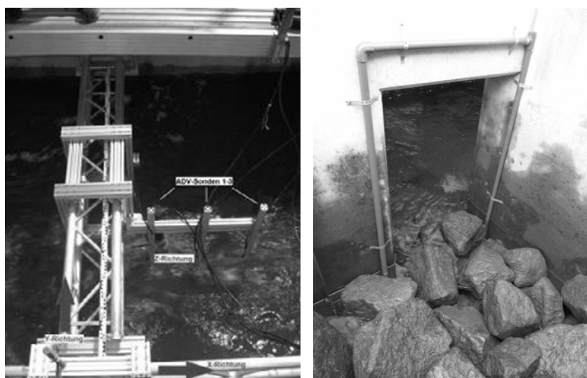
Abb. 4. Strömungsmessungen mit ADV in Koblenz (links), HDX Antenne installiert im Eingang einer Fischaufstiegsanlage
