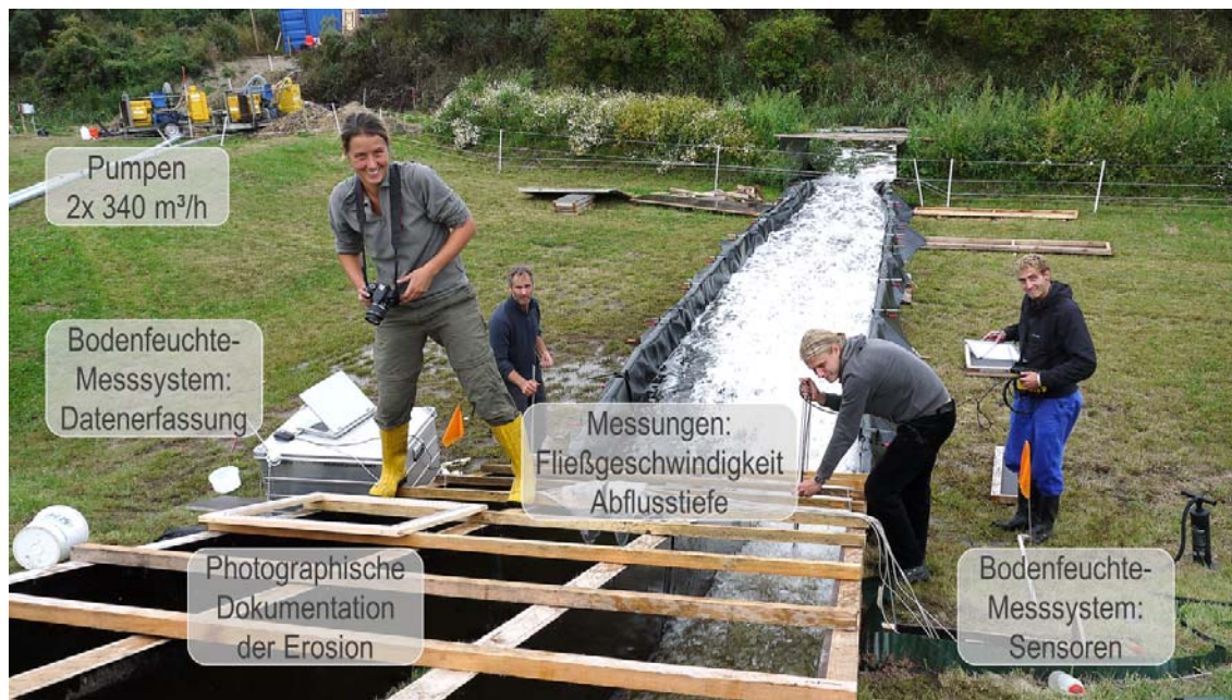
Abb. 3: Überströmungsversuche am DredgDikes-Versuchsdeich
