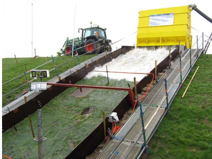
Abb. 6: Beispiel für eine Messung in der Natur – Wellenüberlauf an Kleideich mit Grasbewuchs (Foto: Schüttrumpf)
