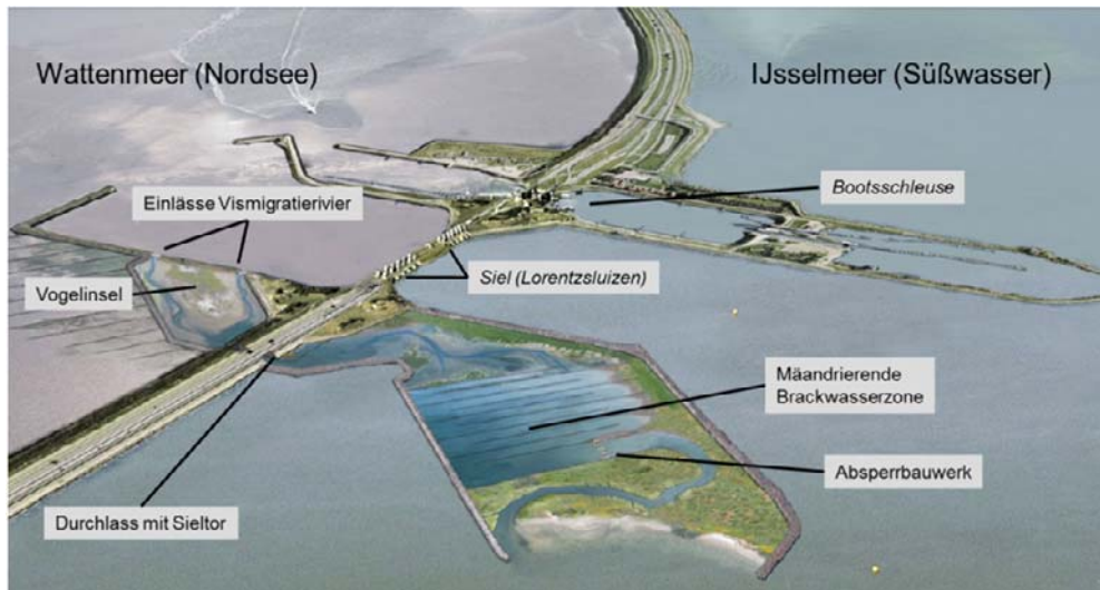
Abb. 3: Entwurf des Vismigratieriviers (geändert nach Programmabureau De Nieuwe Afsluitdijk en Rijkswaterstaat Midden-Nederland, 2015)
