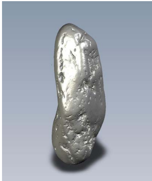
Abb. 1: Mit einem Computertomographen digitalisiertes Sedimentkorn vom Rhein
