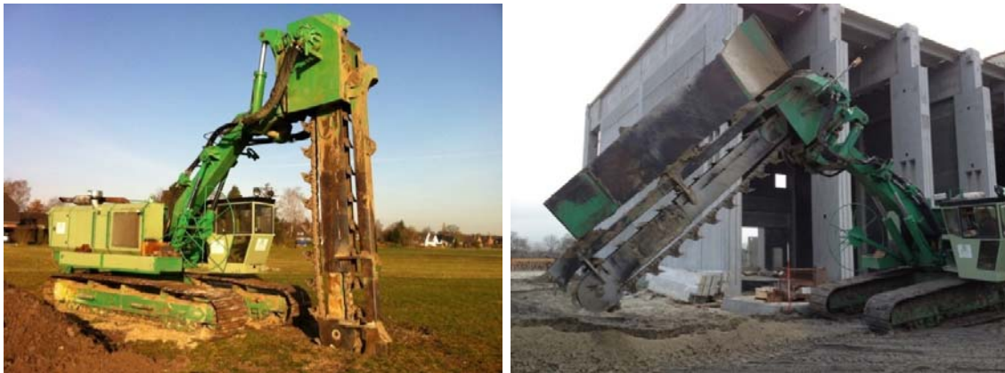
Abb. 4: Tiefenfräse ohne und mit Verbauschlitten (Quelle: Christoffers Kulturbau GmbH)
