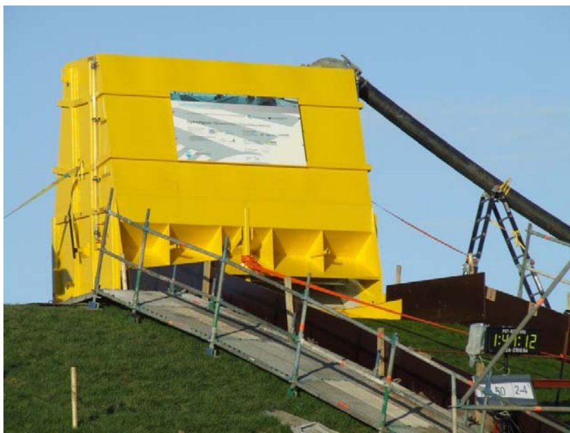
Abb. 2: Der Overtopping Simulator (Foto: Schüttrumpf, 2007)
