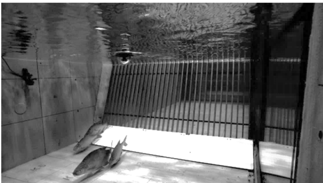
Abb. 1: Ausschnittsmodell, in dem sowohl der Rechen als auch die Fische im Maßstab 1:1 abgebildet werden, um die Größenverhältnisse einzuhalten
