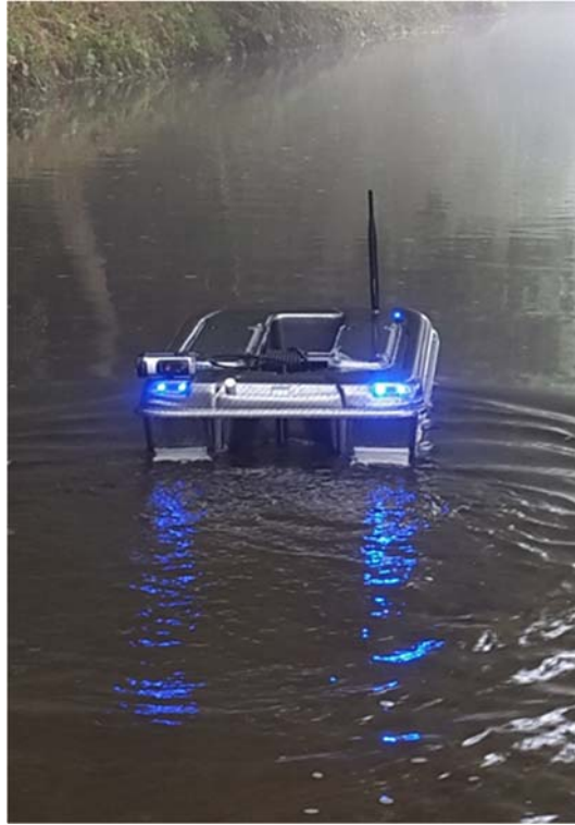
Abb. 3: Ein kleines, ferngesteuertes Messboot im Einsatz auf der Wurm in Aachen
