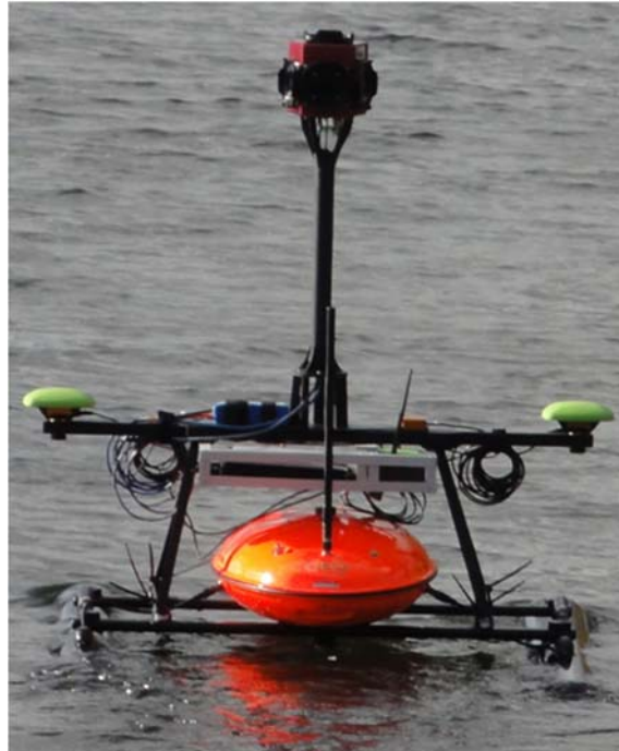
Abb. 2: RiverBoat mit Kameragestell und Doppel-GNSS Antennen auf Einsatzfahrt
