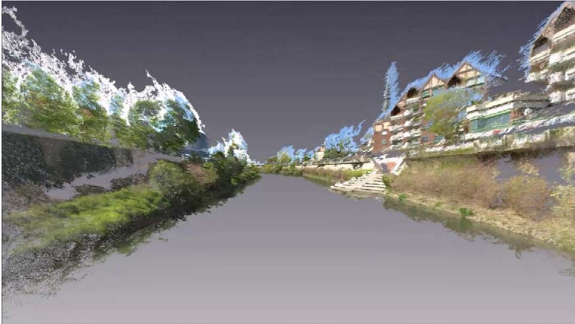
Abb. 6: 3D-Punktwolke eines Gewässerabschnittes auf der Lippe
