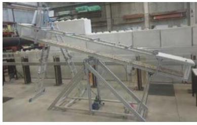
Abbildung 1: Wippe zur Durchführung experimenteller Versuche zu strömungsartigen Erdrutschen. Quelle: IWW, RWTH Aachen University
