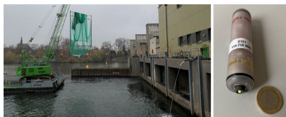
Abb. links: Turbinenauslass an der Wasserkraftanlage Eddersheim während Versuchsvorbereitung; Abb. rechts: Sensorfisch (Quelle: IWW)
