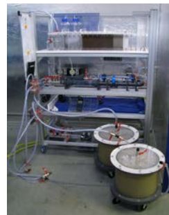
Abbildung: Versuchsstand zur Brunnenerockerung, der im Rahmen des Projekts modifiziert und zur Untersuchung der Verockerung von Filtern unter Deckwerken verwendet wird.
