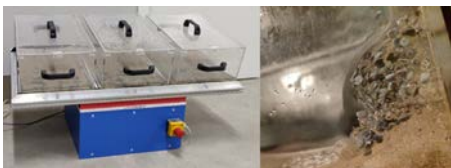
Abbildung: Slosh-Box Versuchsstand (links) und Wellenbrechen in einem der Behälter mit Kunststoffpartikeln. Quelle: IWW, RWTH Aachen University
